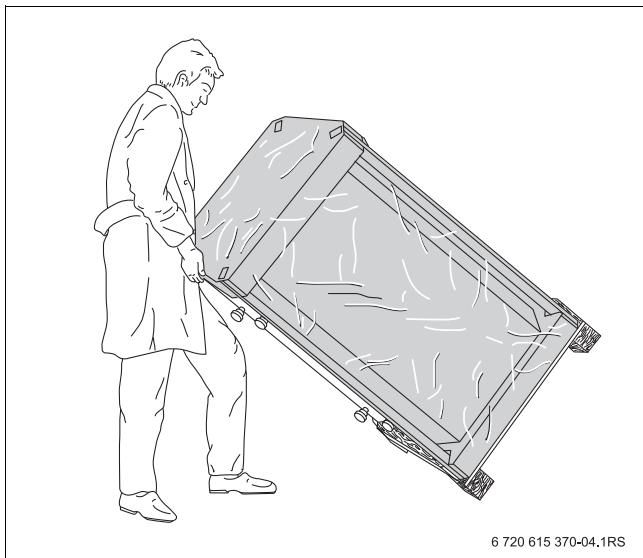
Att. 4 Karstā ūdens tvertnes uzstādīšana
